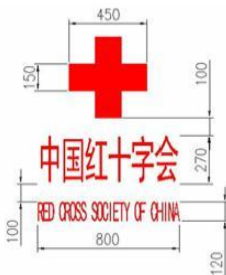
图3 侧墙中间标识内容及尺寸
