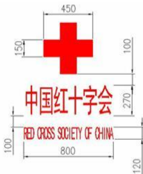
图3 侧墙中间标识内容及尺寸
