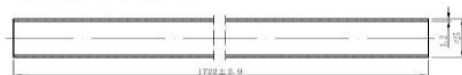
图 B.2 立杆结构及主要尺寸
