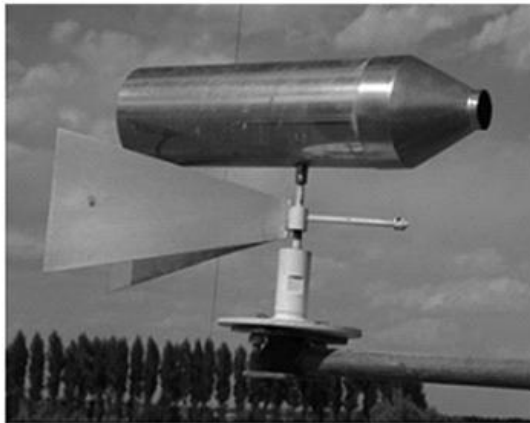
风向跟踪滤袋式沙尘水平通量仪实物图及结构示意图
