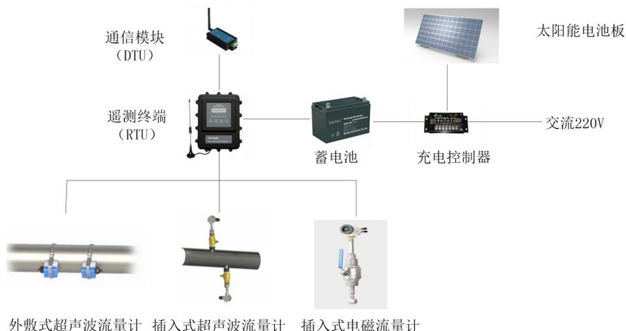
图 1 管道型取水流量自动监测站结构图
