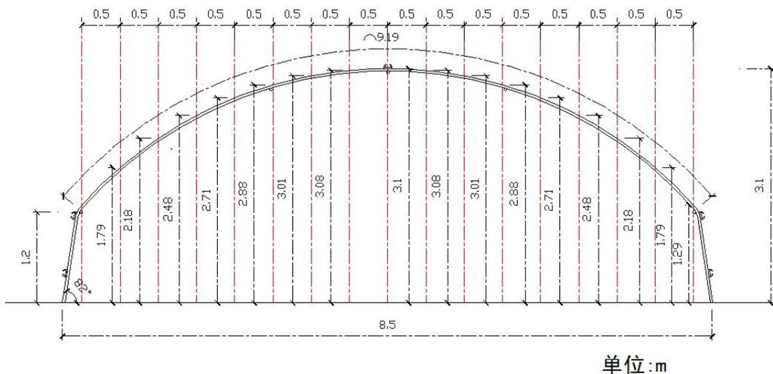
参照以上全钢架塑料大棚拱架施工图(跨度 $8.5\text{m}$ )
